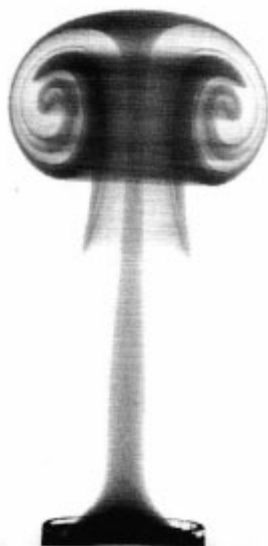
Abb. 1) Gefärbtes Wasser aus einem Rohr in ein Wassergefäß geleitet. Es bildet sofort Rechts- und Linkswirbel, die 3 D ringförmig um den Ausgang erscheinen (Thorus). Jeder Stein im Bach bewirkt sowohl paritätisch das Rechts- als auch das Linkswirbeln des Wassers, was als Naturgesetz angesehen werden sollte... Quelle: „Das sensible Chaos“, Th. Schwenk, Verlag ‚Freies Geistesleben‘ S. 18
